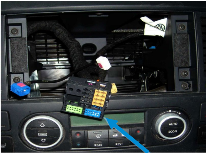
Der CAN-Abgriff erfolgt am originalen Radio-Stecker. The CAN tap is on the original radio connector.
